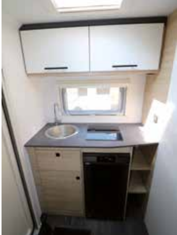
Kompressor-Kühlschrank und Induktionsherd ersparen die Gasanlage
