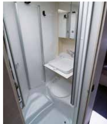
Der Sanitärraum mit dem Klappwaschbecken kann durch die Schwenkwand zur Dusche umfunktioniert werden
