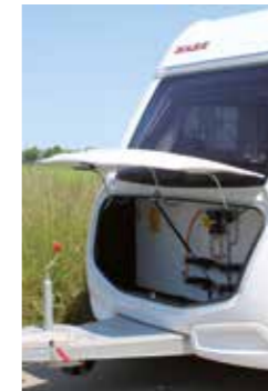
Geräumiger und beleuchteter Deichselkasten, der aber weiter öffnen sollte
