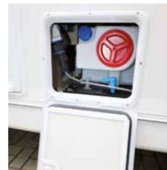
Über die Außenklappe ist das Service-Modul mit Frischwassertank, Ablasshahn und Strom-Einspeisdose bestens erreichbar
